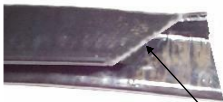
Trim lower edge on an angle
